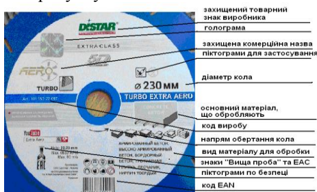
Рис. 1 – Розшифровка даних, що зазначені на алмазному крузі відрізного типу «TURBO»
